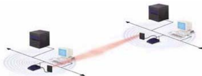
Fig. 6: Interconexión de redes LAN mediante antenas direccionales.
